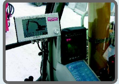
SISTEMA AUTOMÁTICO DE HINCA
