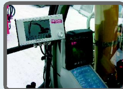
SISTEMA AUTOMÁTICO DE HINCA
