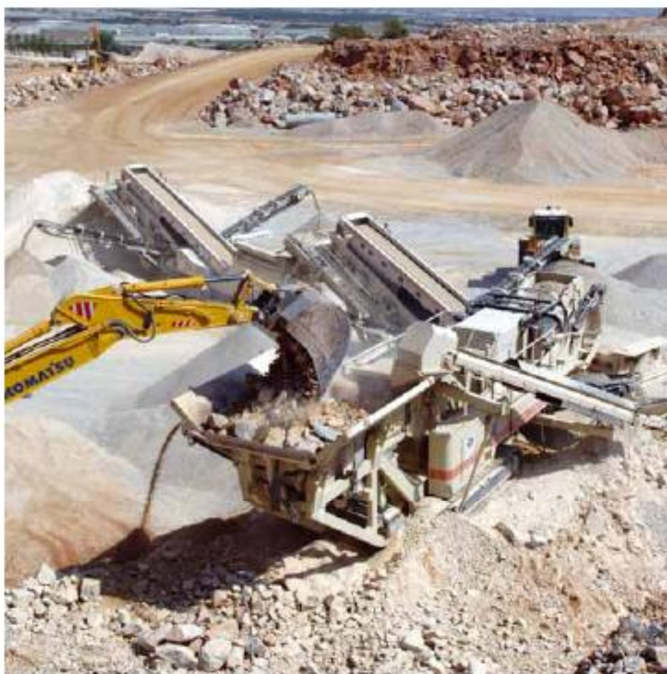
La flota de Lokotrack consistente en una planta de trituración LT 1213S y dos cribas móviles ST 352, obtiene cinco productos finales calibrados con precisión en la cantera El Cabezo.
